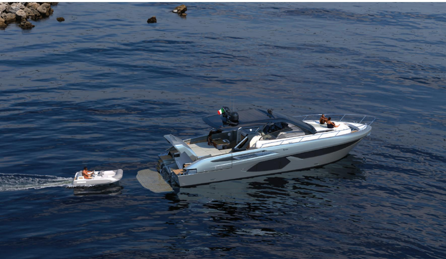
L'hangar di poppa consente di stivare un tender fino a 2,85m, con la comodità di un sistema di gonfiaggio rapido integrato. Il varo e l'alaggio del tender sono resi semplici da un verricello e un sistema di rulli che agevolano il suo movimento.
